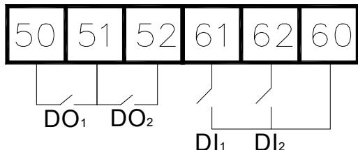
AMC96L-E4(3)开关量输入输出端子：“50, 51”为开关量输出端子号，“60, 61, 62, 63, 64”为开关量输入端子号。
